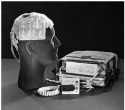
Thiết bị Novo TTF-100A làm chậm hoặc đảo ngược sự phát triển của các khối u não
